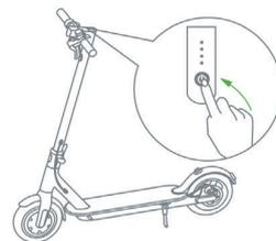
Presiona el botón de encendido y manténlo presionado por 2 segundos para prender el scooter. Cuando este encendido, vuelve a apretar el botón para apagar y encender la luz, luego vuelve a apretar el botón dos veces para activar el modo normal y el modo de ahorro de energía. En el modo de ahorro de energía una luz se pondrá verde en el tablero y el equipo limitará su potencia y velocidad.
